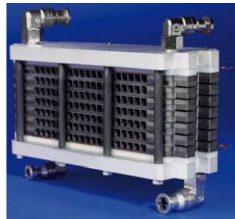
Test-Stack aus einem Brennstoffzellen-Teststand des Fraunhofer ISE. Quelle: Fraunhofer ISE.
