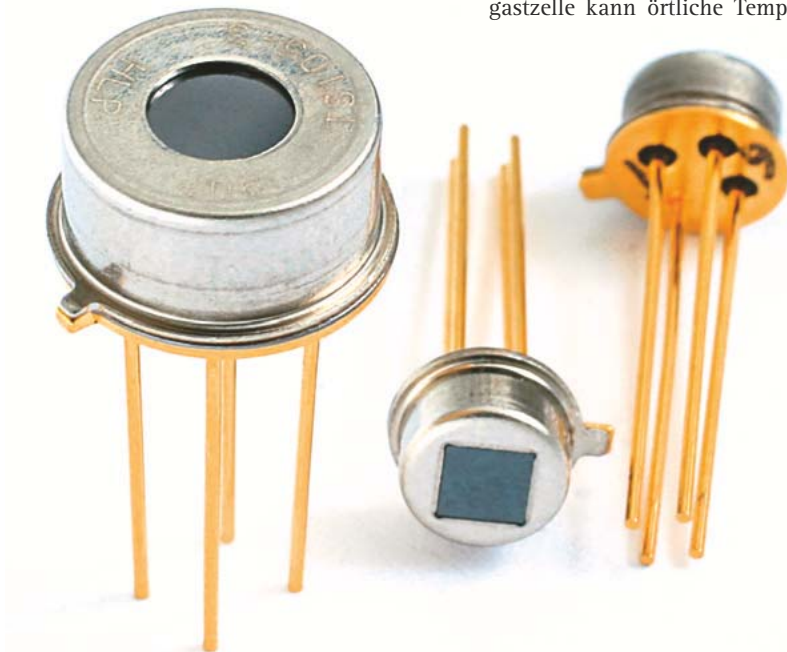
Infrarot-Sensoren in gehäuseter Komponentenform verschiedener Bauform. Quelle: HL-Planartechnik GmbH.
