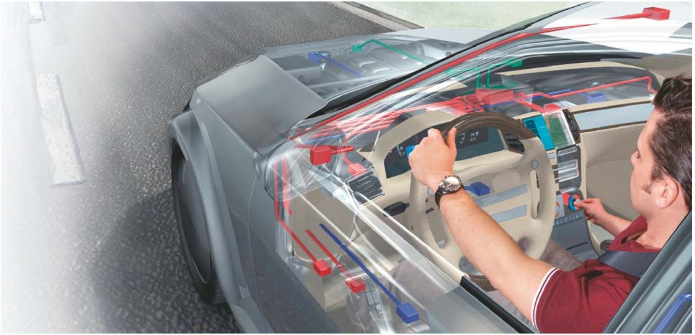
Intelligente Bus-Systeme ermöglichen die effiziente Vernetzung von Steuergeräten, Sensoren und Aktuatoren im Fahrzeug. Quelle: Elmos Semiconductor AG.
