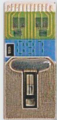
Der Luftmassensensor von HL-Planartechnik. In der unteren Hälfte ist mittig die Membran zu erkennen. Quelle: HL-Planartechnik GmbH.
