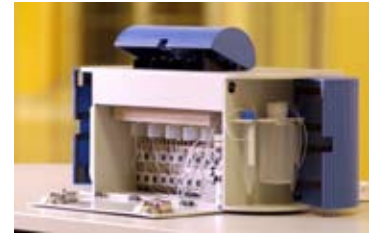
Assayprozessor zur vollautomatischen Bearbeitung mehrerer Biochip-Kartuschen. Quelle: Fraunhofer IZM.
