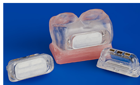
Intraorales Medikamentendosiersystem „BuccalDose“ zur Integration in zwei künstliche Zähne einer Zahnprothese. Quelle: HSG-IMIT – Institut für Mikro- und Informationstechnik der Hahn-Schickard-Gesellschaft e.V.
