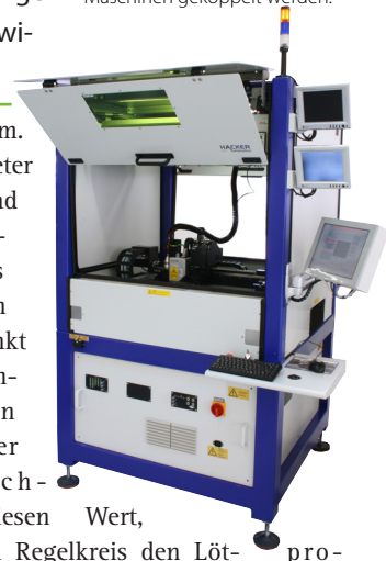
Die Mikro-Laserlötanlage „VICO 520 Laser“ kann als Einzelsystem realisiert oder über SMEMA-kompatible Transportbänder in Fertigungsanlagen mit anderen Maschinen gekoppelt werden.
