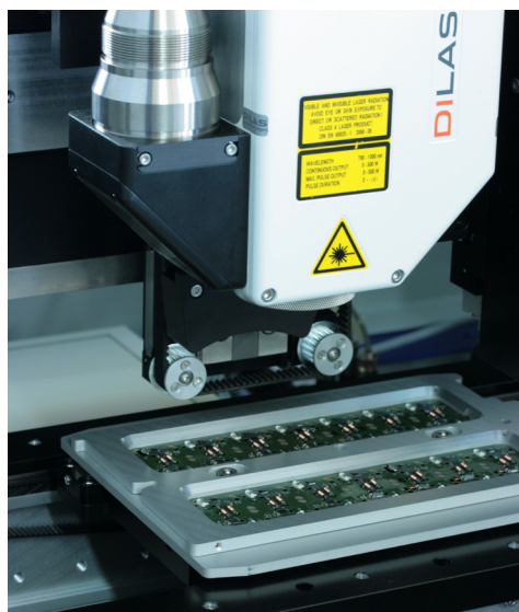
Der auf dem LASCON-Lasermodul von DILAS basierende Laserlötkopf der Häcker Automation GmbH kann Spotgrößen von minimal 0,3 mm erzeugen. Über einen Steuerrechner können Prozessingenieure für jeden Lötprozess ein separates Lötprofil erstellen. Quelle: Häcker Automation GmbH
