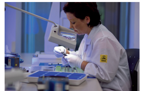
Mikrometergenaue Montage von Hightech-Pumpen Quelle: HNP
