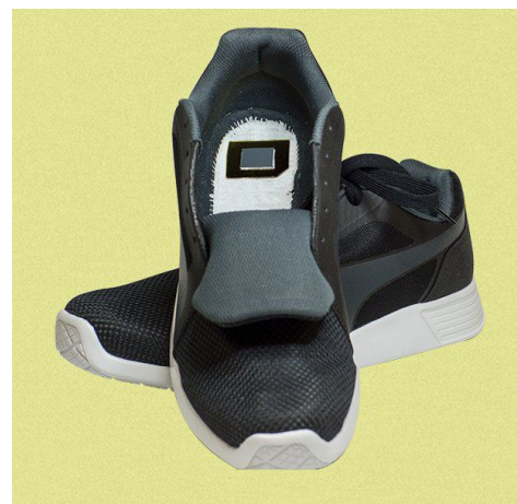
Polymer-Energiewandler eingebettet in einen Laufschuh Quelle: Fraunhofer IPMS
