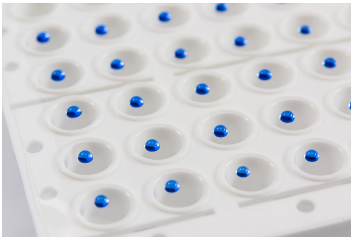
Mikrotiterplatte mit den darauf abgelegten Tropfen mit jeweils einer Zelle. Quelle: Fraunhofer IMM
